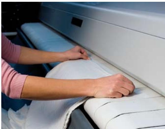
Protección de manos con doble sensor controlando la posición activa y de reposo.
