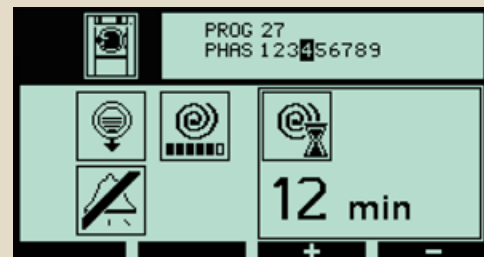
La pantalla Inteli indica las operaciones de la máquina en cada fase de lavado
